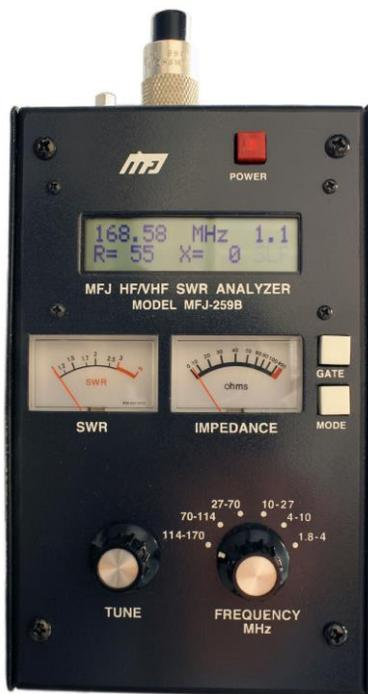
*L'analizzatore di parametri d'antenna MFJ-259B*
