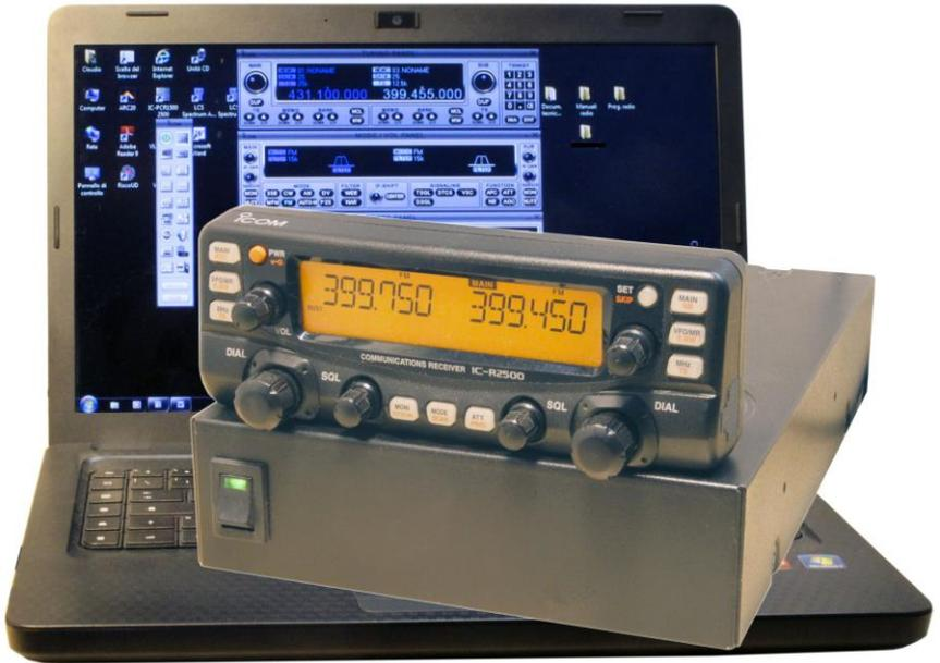
Fig.15c Il complesso computerizzato di ricezione multibanda Icom PC-R-2500. Riceve da 10 kHz a 3300 MHz
